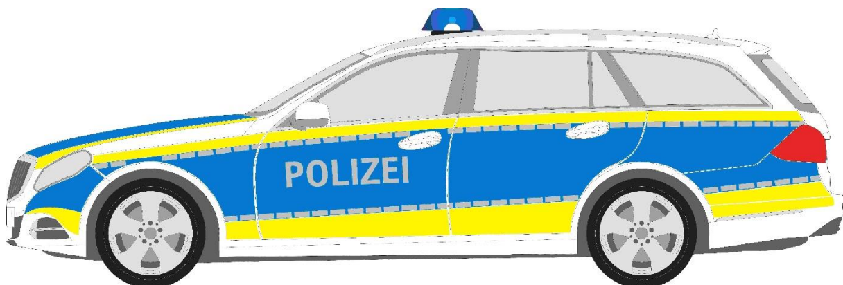
A 2-2 Anbringung der Folien im Seitenbereich
