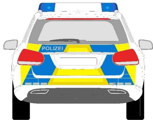
A 2-3 Anbringung der Folien im Heckbereich
