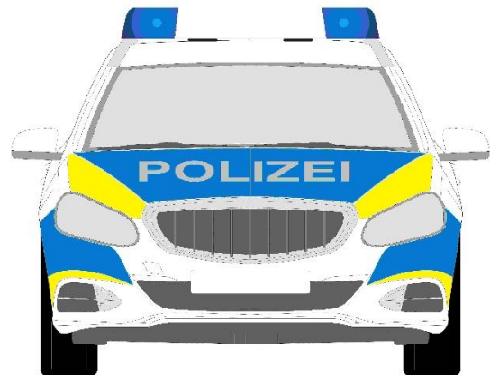
A 2-1: Anbringung der Folien im Frontbereich
