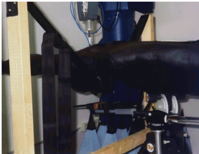
Bild 52: Die Anordnung zur Messung der spezifischen Absorptionsrate innerhalb eines Ganzkörperphantoms bei Verwendung der Handfunkgeräte FuG 10a, FuG 13a und AEG Teleport 10.
