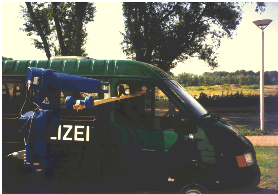
Bild 51: Plazierung der Roboterarmverlängerung sowie der Feldsonde zur Vermessung der Feldstärke auf den Vordersitzen des Fahrzeugs Ford Transit.
