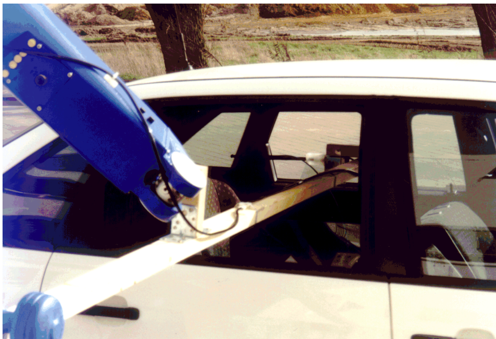
Bild 5: Platzierung der Roboterarmverlängerung sowie der Feldsonde zur Vermessung der Feldstärke auf den Rücksitzen des Fahrzeugs VW Passat Limousine B4.
