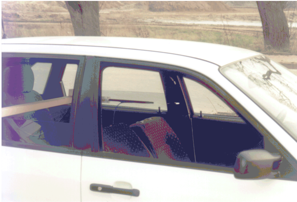
Bild 6: Platzierung der Roboterarmverlängerung sowie der Feldsonde zur Vermessung der Feldstärke auf den Vordersitzen des Fahrzeugs VW Passat Limousine B4.
